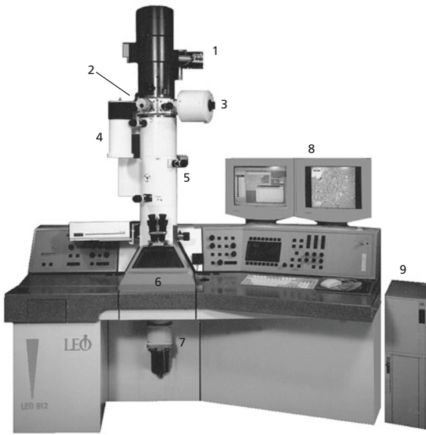
Abb. 1.3 Elektronenmikroskop (EM). Die Elektronenstrahlen gehen vom Strahlerzeuger (1) aus und durchlaufen im Tubus (Vertikalröhre, 5) von oben nach unten ein Kondensorenliniensystem. Dann gehen sie durch das in das Hochvakuum des Tubus eingeschleuste Objekt (Präparatschleuse, 2) mit seitlichem Dewargefäß (4) für flüssigen Stickstoff zur Objektraumkühlung ([3] motorisierte Kippvorrichtung für das Präparat), weiter durch die Felder der abbildenden elektromagnetischen Objektiv- und Projektivlinsen (in 5), bis sie schließlich auf einen fluoreszierenden Leuchtschirm treffen. Das hier erscheinende Endbild kann durch ein Einblickfenster (6) oder auf Monitoren (8) beobachtet oder digital gespeichert werden (Digitalkamera, 7). Der Restgasdruck im Tubus wird durch Hochvakuumpumpen auf Werten unter ein Millionstel des Atmosphärendrucks gehalten. (9) Computertower für Bildakquisition und -verarbeitung. Der Preis solcher Transmissionselektronenmikroskope (TEM) liegt bei mehreren 100.000 Euro. (Zeiss, Jena)
