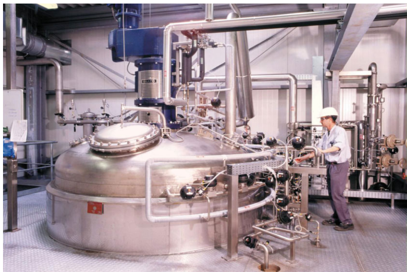
ABB. 5 Fermenteranlage zur Produktion von Paclitaxel mit Hilfe der Zellkulturtechnik bei der Firma Phyton in Ahrensberg.
