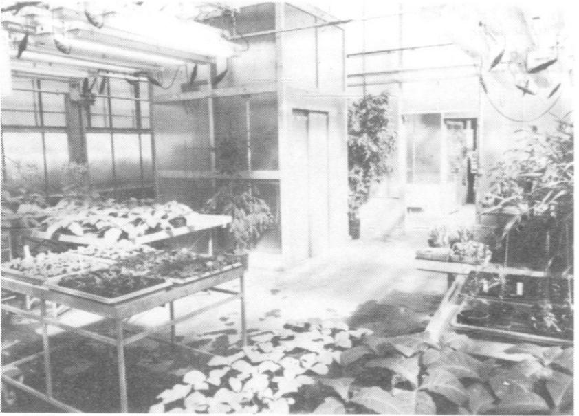
Versuchsgewächshaus mit Zusatzleuchten und Blick auf Fahrstuhl, in welchem die hier angezogenen Pflanzen in die Bestrahlungsräume im Keller transportiert werden können.
